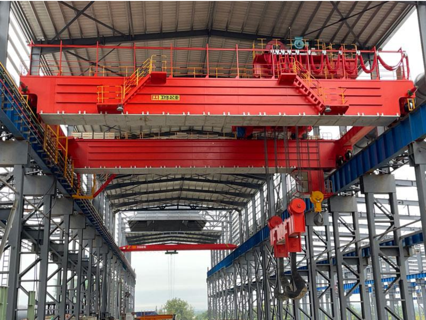
Ponte rolante de viga dupla
