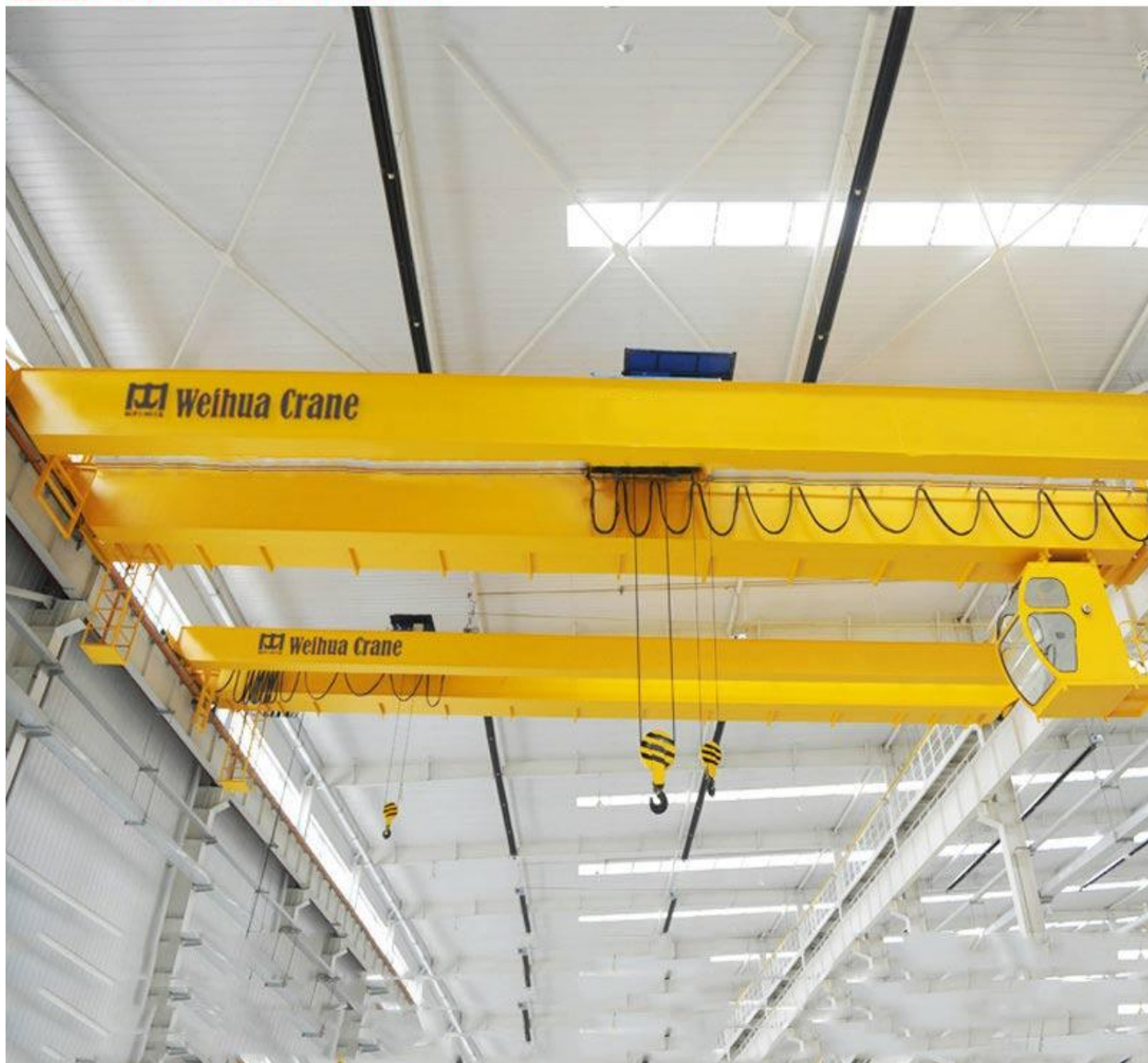
Ponte rolante de viga dupla
